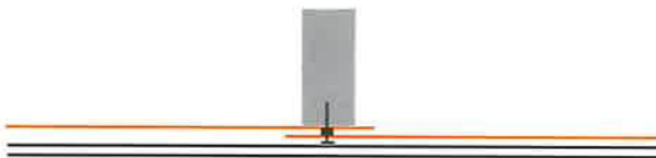
Figur 14: Skarvning mellan de lufttäta skikten sker genom att lägga en sträng fogmassa längs skarven och sedan klämma denna med hjälp av t ex en gipsskiva.
