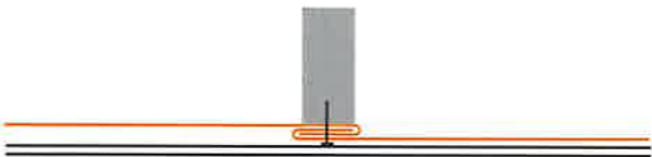
Figur 13: Skarvning mellan de lufttäta skikten sker genom att foliernas kanter viks om varandra.
