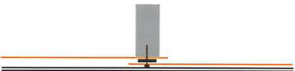
Figur 15: Skarvning mellan de lufttäta skikten sker genom dubbelhäftande tätningsband.
